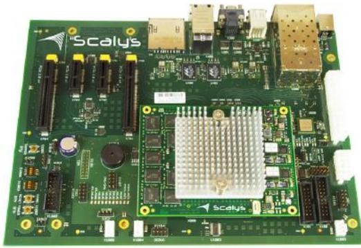
**A SAMPLE OF A SCALYS SYSTEMS ON MODULE WITH A CUSTOMIZED CARRIER**
